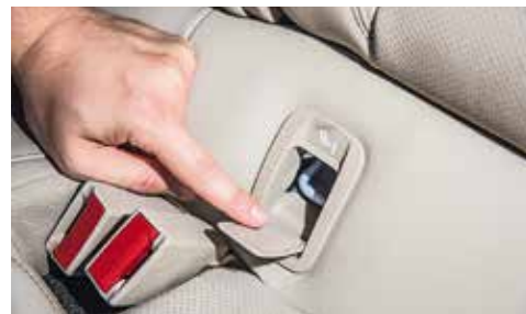
Kotvící body systému Isofix jsou výborně dostupné, sem se budou autosedačky dávat jedna radost.
