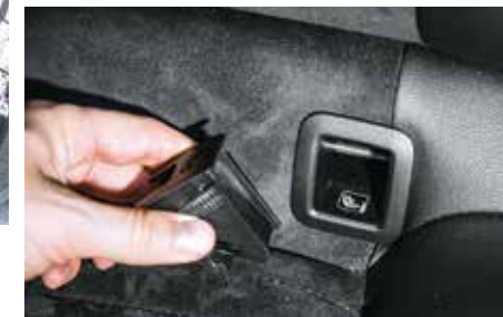
Isofixy v Passatu jsou „utopeny“ hlouběji v opěradle, je navíc nutné vycvaknout a někam odložit plastový kryt.
